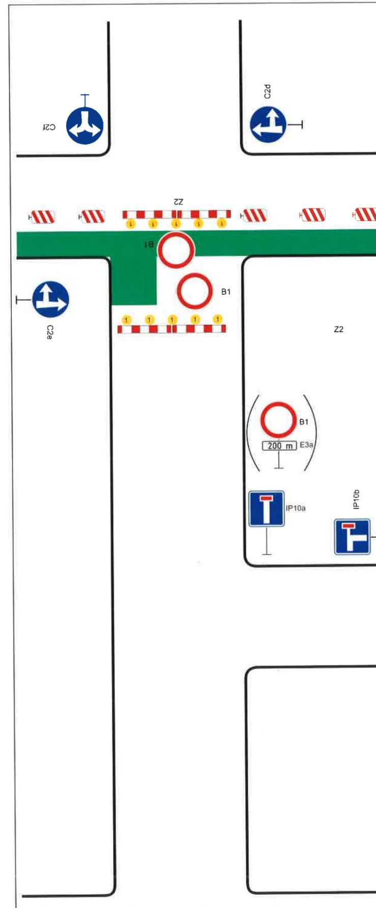
podélná uzávěra oboustrannými směrovacími deskami
