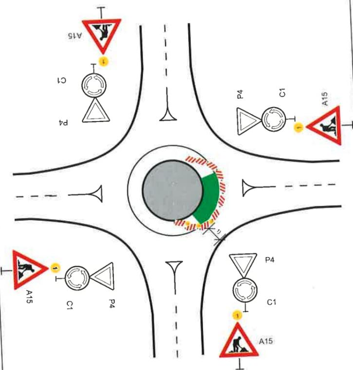
příčná uzávěra jednostrannými směrovacími deskami
